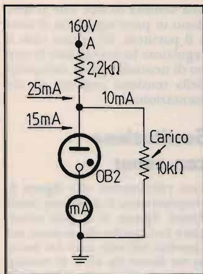
② Collegando un carico ai capi del tubo, la tensione non cambia, perché la corrente totale resta la stessa. La corrente per il carico è "fornita" dal tubo. Se il carico assorbe più di 20 mA, il tubo si spegne. Lo si rimette in funzione aumentando la tensione di alimentazione o diminuendo il resistore da 2,2 kohm.
