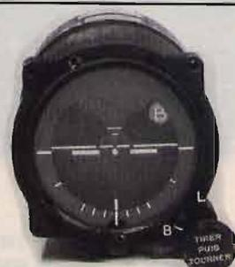
**1015018 Orizzonte artificiale Sperry** con giroscopio ad aria compressa. cm 11x11x19. In ottime condizioni **L. 25000**
