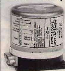
impiegato su missili, con motore a molla "Spring Motor"; la molla, una volta scarica si può ricaricare. Oggetto di grande precisione meccanica, originale USA.
