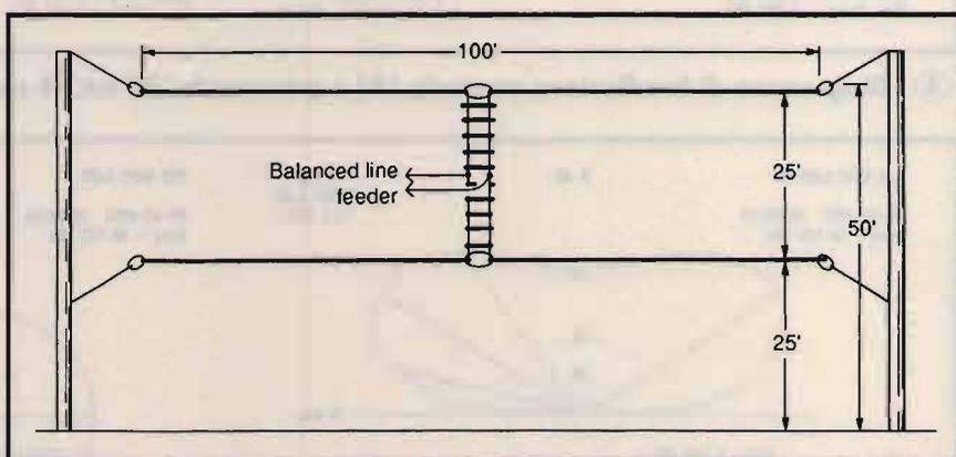
① Il progetto dell'antenna. 100' = 30,5 m; 50' = 15,25 m; 25' = 7,6 m.
