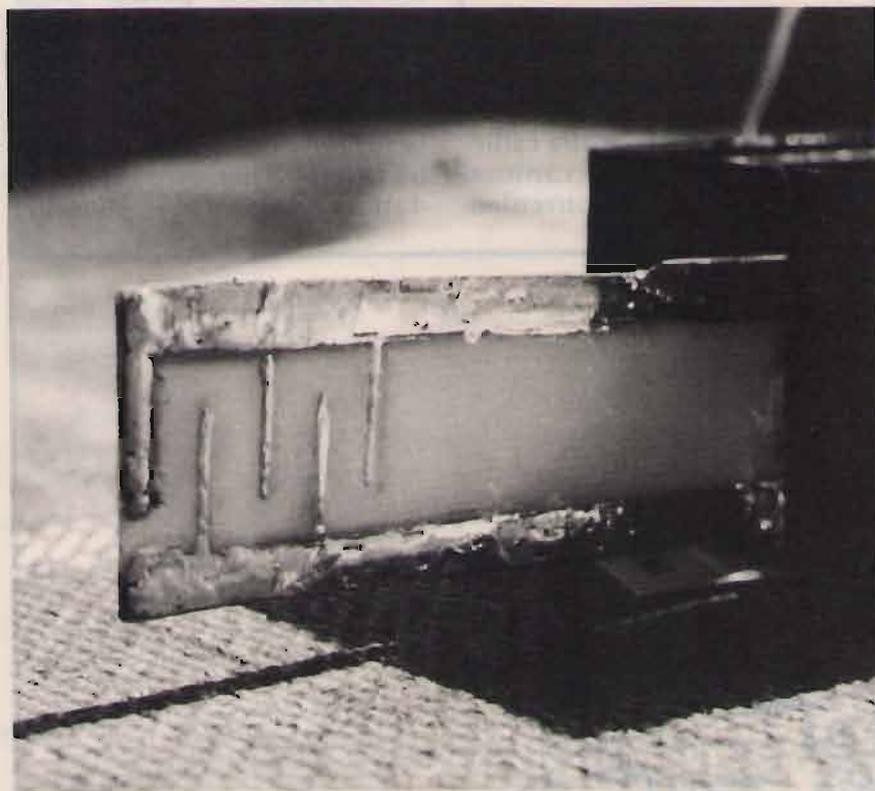
possibili interferenze. Per la taratura procedere come segue. Collegare il manipolatore al keyer. Ruotare  $P_1$  e  $P_2$  completamente in senso antiorario e accendere con S: il paddle non dovrebbe generare alcun segnale. Successivamente agire su  $P_1$  e  $P_2$  per innescare l'emissione dei caratteri manipolando il paddle. La taratura è finita: a questo punto provare ad operare come al solito. Se il
