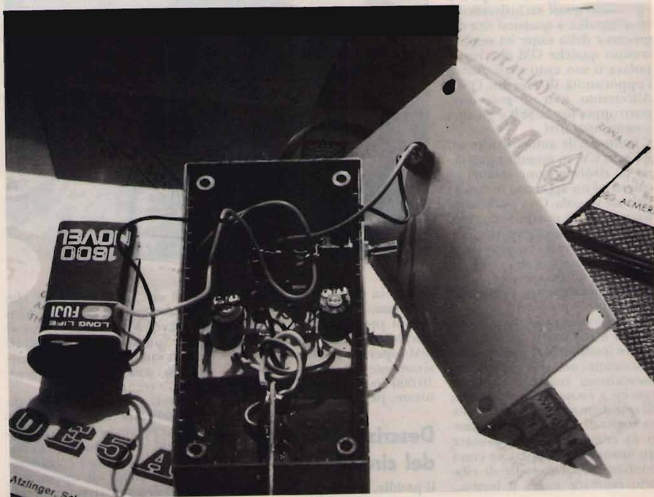
zionale sono molto più grandi di uno di tipo elettronico come quello che vado a descrivervi. Si tratta di un normale Darlington (figura 1) composto da due transistor. Il tocco delle dita mette a massa la base di  $Q_1$  che entra in conduzione ed agisce sulla base di  $Q_3$  il quale a sua volta, entrando in conduzione, chiude il circuito tra collettore ed emittore. Inutile dire che i circuiti poc'anzi esposti sono due: uno genera i punti e un altro le linee.
