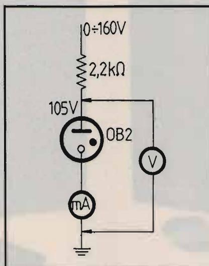
① **Circuito per verificare il funzionamento di un tubo stabilizzatore. L'innesco avviene ad una tensione leggermente superiore a quella di stabilizzazione. La corrente è 5 mA e la massima 30 mA.**
